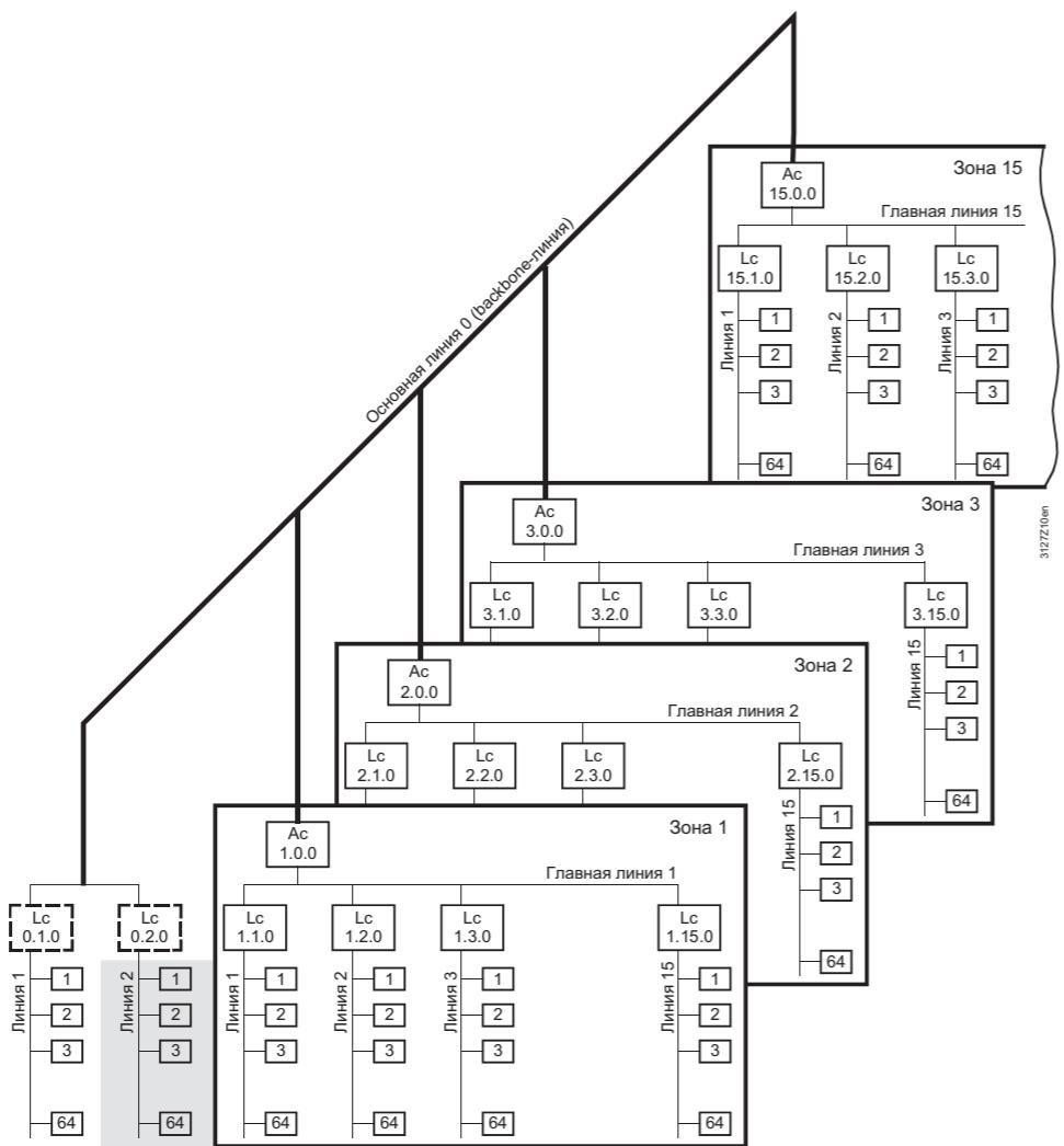
Замечание: Устройства Synco выделены на схеме серым цветом. При добавлении дополнительных зон и линий необходимо использовать сопряжители.
