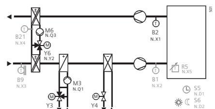
Управление температурой вытяжного воздуха (в помещении) и контроль точки росы при помощи двух регистров нагрева, регистра охлаждения, увлажнителя и вентилятора. Дополнительно:
