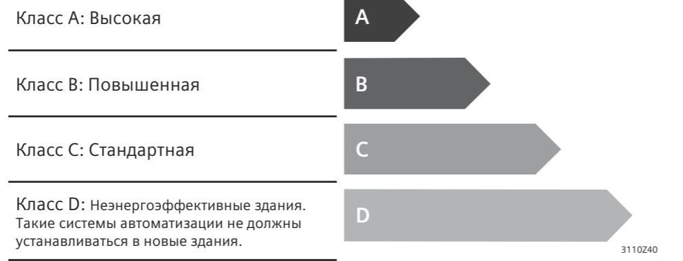
В системах, соответствующих классу А, экономия энергии достигает 30% по сравнению со стандартными (класс С). Устройства Synco соответствуют требованиям к оборудованию в системах класса А.
