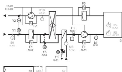
Управление температурой приточного воздуха при помощи рециркуляционных заслонок и регистром горячей воды.
