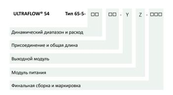
В дополнении к базовым параметрам должны быть выбраны: модуль выхода (Y), модуль питания (Z), а также цена импульса (CC) и длительность импульса (E).
