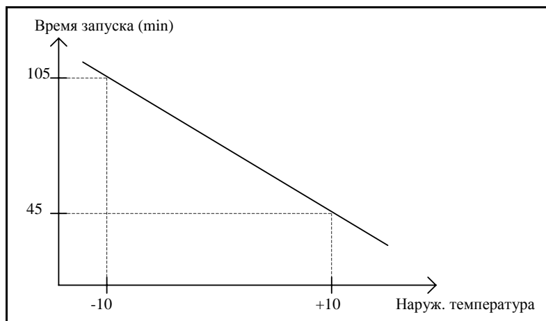
Рис. 2. График описывает зависимость между наружной температурой и временем запуска.
