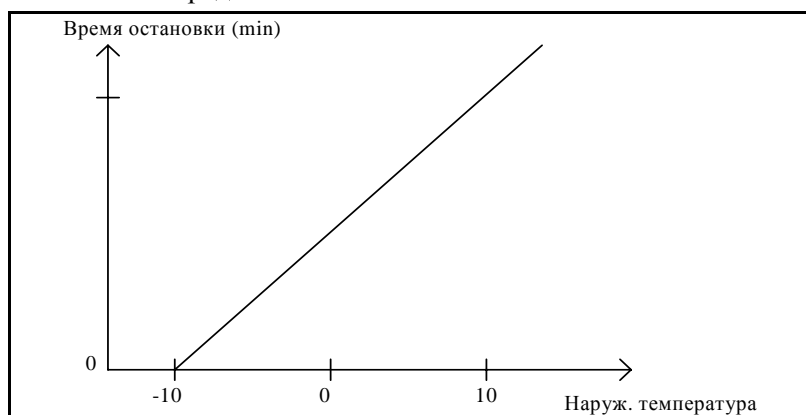
Рис. 4. График отношения наружной температуры и времени остановки. Значение по умолчанию на графике не указано.
